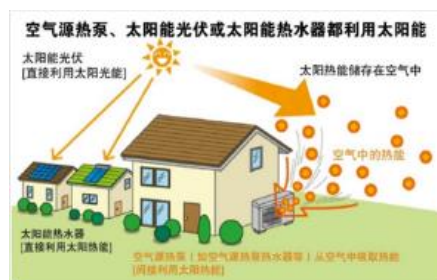
图 1-3 利用空气热能（太阳能）示意图
